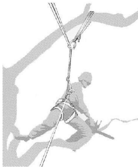
Figura A.3 -- Ejemplo del desvío del cable principal a un dispositivo de suspensión adicional.
